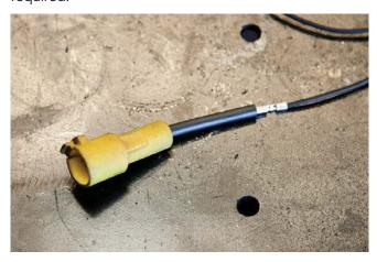
**STEP 28** - INSTALL O<sup>2</sup> SENSOR
